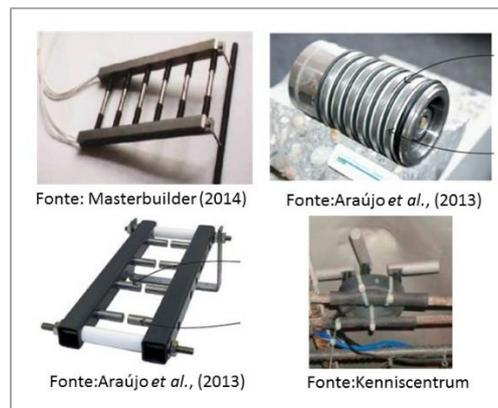
De acordo com Araújo *et al.*, (2013) no Sensor escada (Anode Ladder) da empresa Sentsortec e no Sensor 900 (*Concrete Multi-Depth Sensor, Model 900*), da empresa *Rohrback Cosasco Systems*, as barras de aço-carbono constituintes do ânodo são retas e estão posicionadas em paralelo. No sensor de anéis expansivos (*Expansion Ring Anode*), também da empresa *Sentsortec* em lugar de barras são usados anéis que estão posicionados uns sobre os outros.
