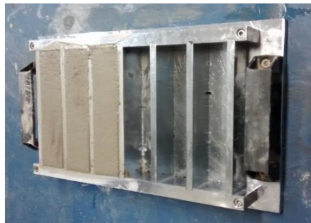
Figura 6 - Corpos de prova prismáticos para ensaio de resistência à tração e compressão
