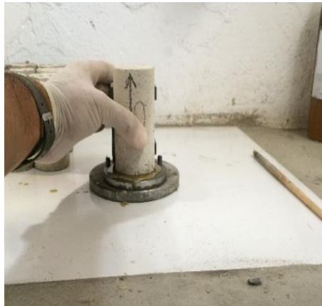
Figura 8 - Realização do nivelamento da superfície com a solução de enxofre
