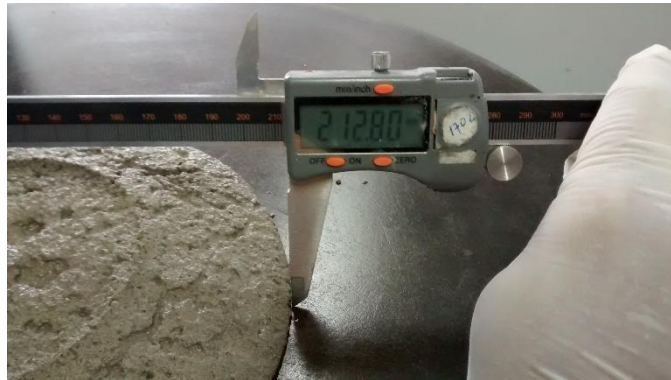
Figura 5 – Detalhe da medição do diâmetro de espalhamento
