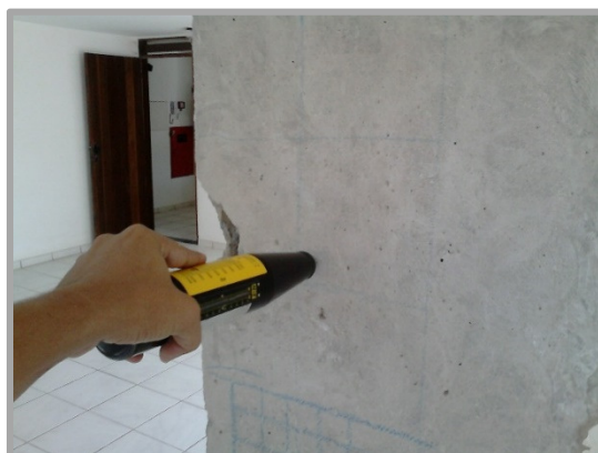
Figura 6 –Detalhes do esclerômetro – Fonte Próprio Autor
