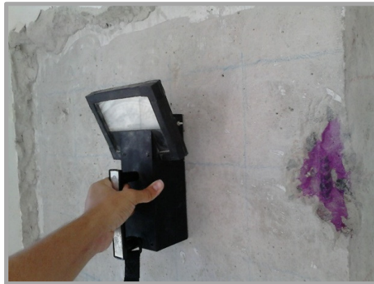
Figura 9 – Detalhe do localizador de barras – Fonte Próprio Autor
