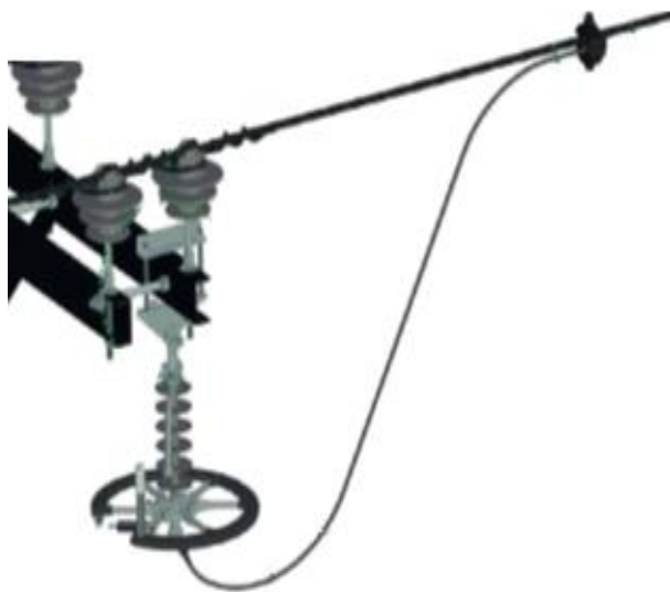
Figura 4: Modelo SAd20z instalado no pino de fixação do isolador [5].
