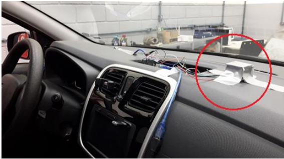
Figura 3: Posição do acelerômetro inercial no painel.
