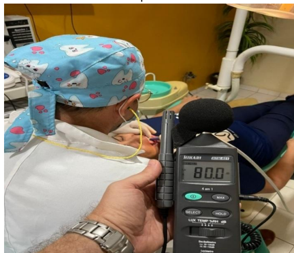
Figura 4 – Pico de ruído com acionamento do compressor.
