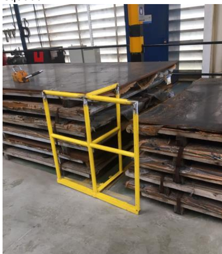
Figura 19 – Guarda corpo do estoque de chapas na altura adequada
