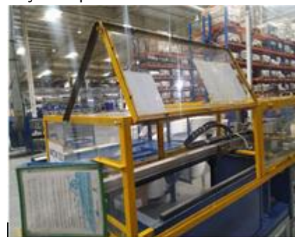
Figura 6 – Máquina de corte de separador com travas de segurança nas portas.
