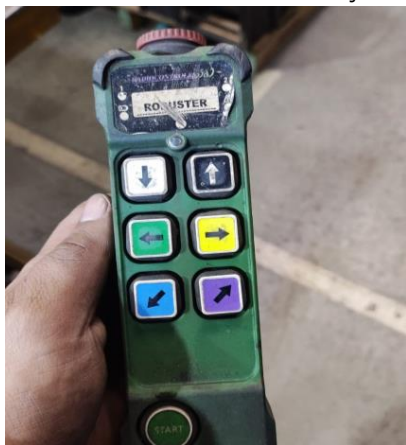
Figura 16 – Controle da talha em condições de uso
