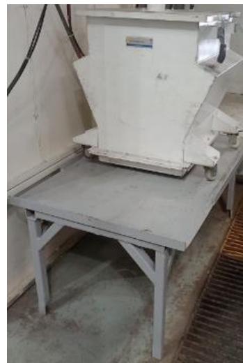
Figura 15 – Coletor de tintas com base restaurada
