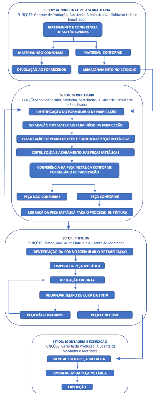
Figura 2 – Fluxograma do processo produtivo da metalúrgica.
