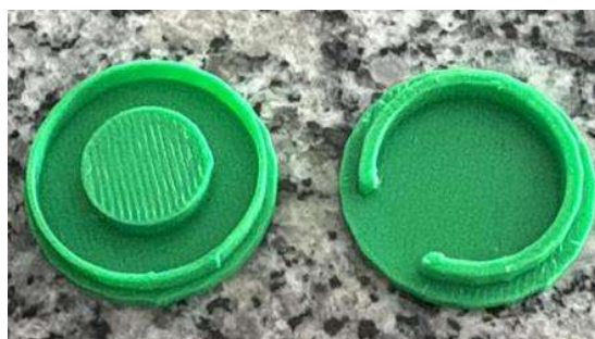
Figura 2 – Encapsulamentos Impressos em 3D para estabilização mecânica dos sensores FSR.
