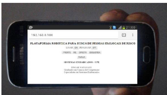
Figura 18: Comunicação do ESP8266 com o celular.
