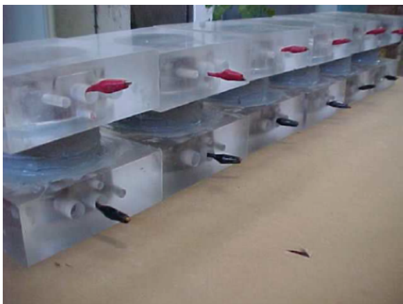
Figura 1: Extremidades das amostras imersas em solução de hidróxido de sódio e cloreto de sódio.
