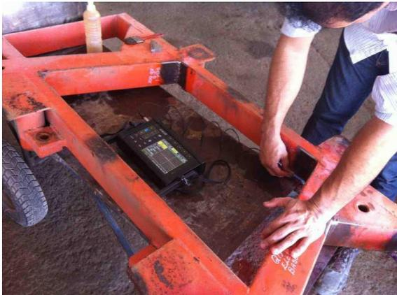
**Figura 19:** Ensaio por ultrassom
