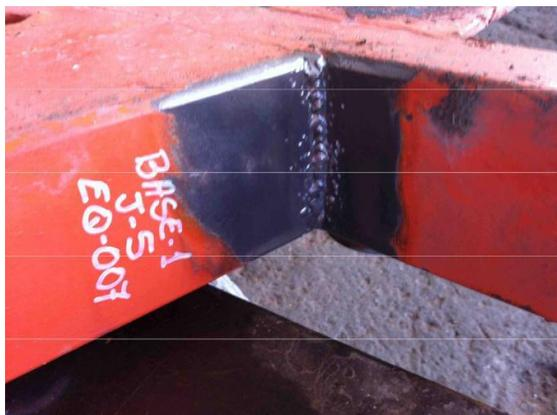
**Figura 8:** Ensaio visual da junta 5
