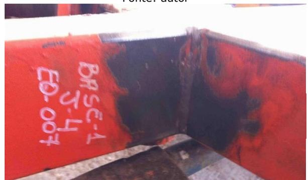
**Figura 7:** Ensaio visual da junta 4
