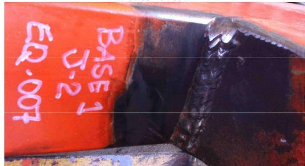
**Figura 5:** Ensaio visual da junta 2
