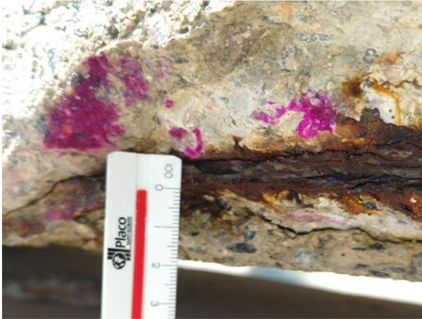
Figura 11: Medição do recobrimento inferior da peça.
