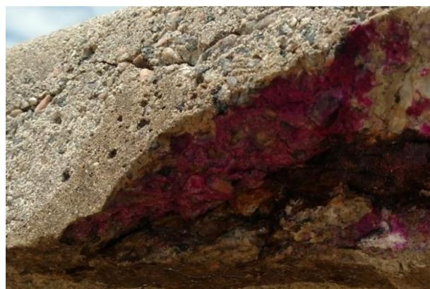
Figura 6: Evidência da contaminação por dióxido de Carbono
