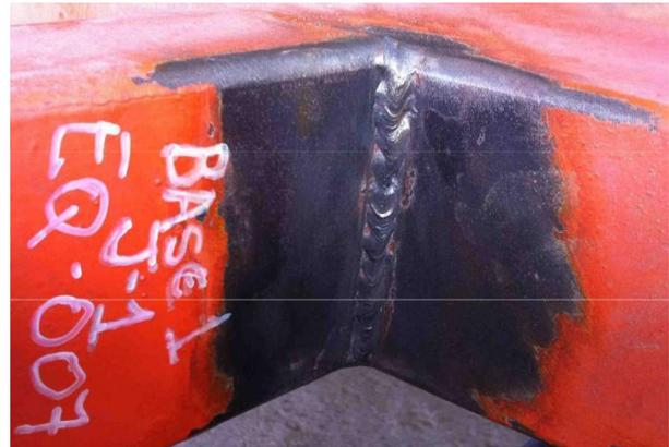
**Figura 4:** Ensaio visual da Junta 1
