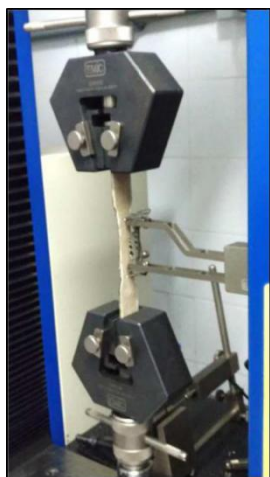
Figura 7: Ensaio destrutivo de tração da madeira balsa. Fonte: Autor.
