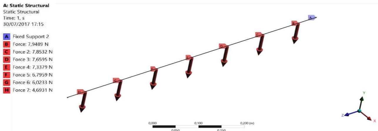
Figura 13: Modelagens de forças na longarina. Fonte: Autor.
