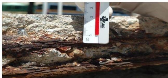
Figura 10: Medição do Recobrimento superior da peça. Fonte: Os autores.
