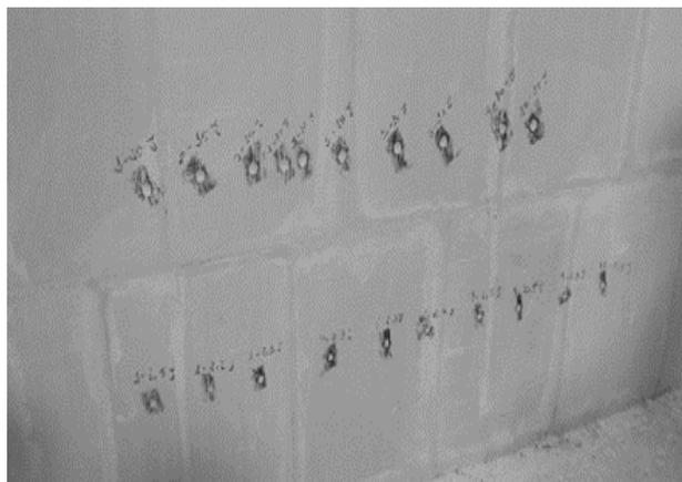
**Figura 3** – Mossas do ensaio de corpo duro.
