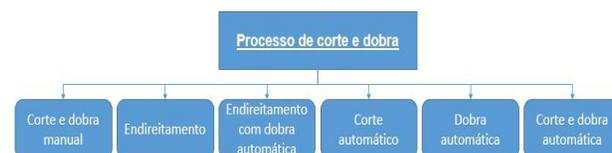
Figura 1: Processo de corte e dobra Fonte: [2]
