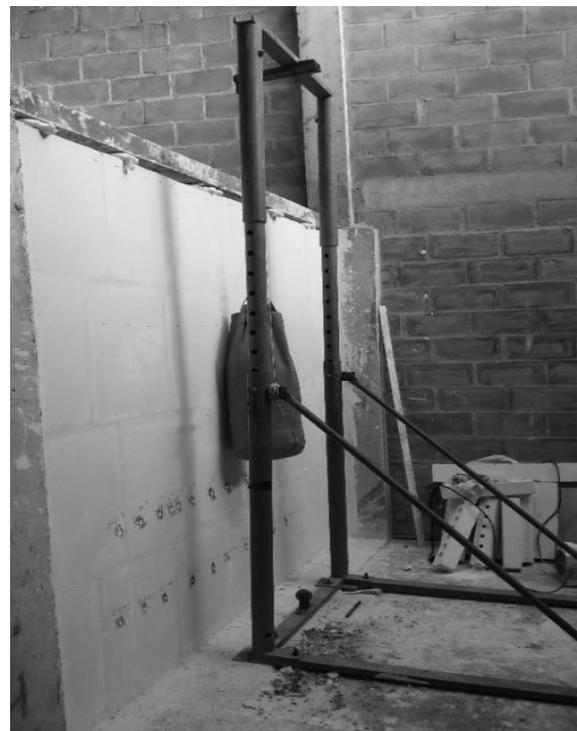
**Figura 8** - Saco de areia suspenso por cabos.
