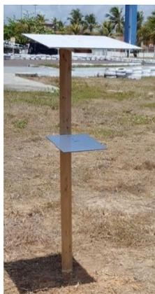
**Figura 2:** Materiais utilizados no suporte da vela úmida.
