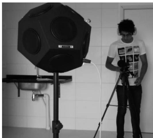
A intensidade das ondas sonoras emitidas pela fonte foi mantida elevada o suficiente para que, juntamente com o ruído de fundo, atingisse 110 dB. Isso garante uma diferença de, pelo menos 10 dB entre o ruído de fundo e o de recepção, como recomenda a norma ISO 16283-1 [24], conferindo eficiência à compilação de dados por parte do
