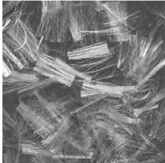
Figura 7: Fibras de polipropileno [12].
