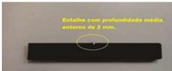
Figura 7: Preparação do corpo de prova.
