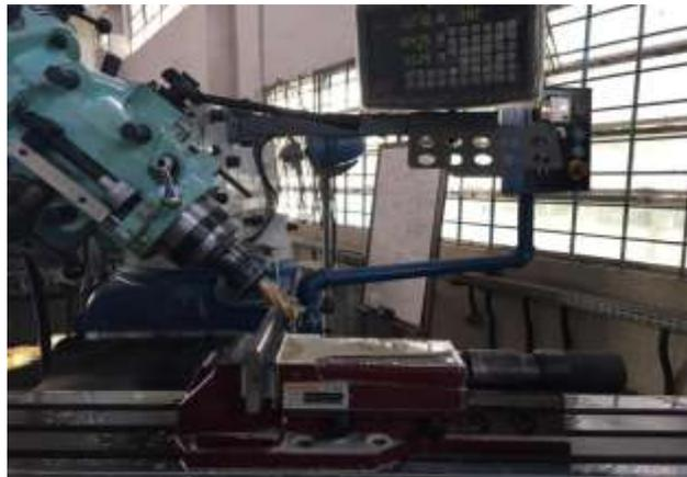
Figura 1: Chapa em processo de usinagem.
