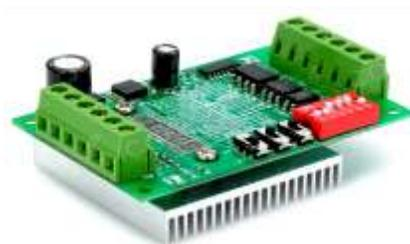
Figura 10. Módulo do Drive TB6560HG
