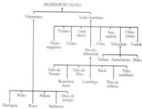
Figura 1: Classificação dos medidores de vazão. Fonte: ABNT NBR 10396-1988.
