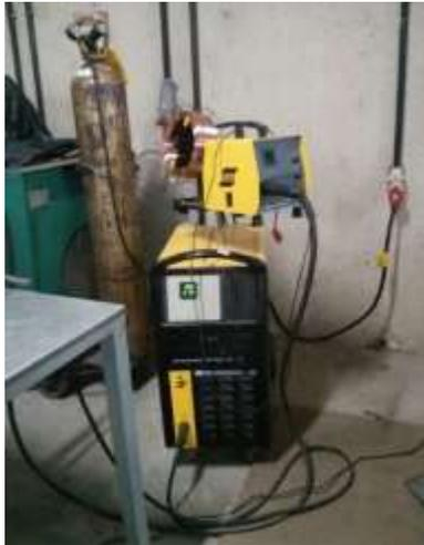
Figura 2: Máquina de soldagem MAG semiautomática.
