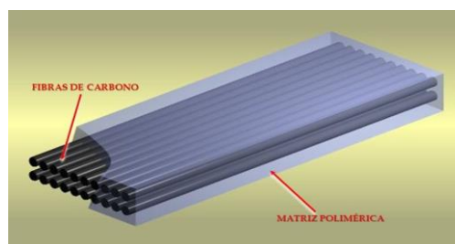
Figura 2: Representação de um compósito estruturado com fibras de carbono.
