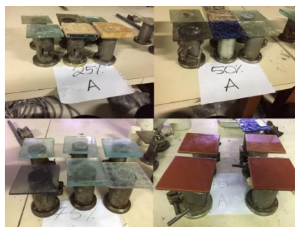
Figura 3: Corpos-de-prova de argamassa de cada traço executado
