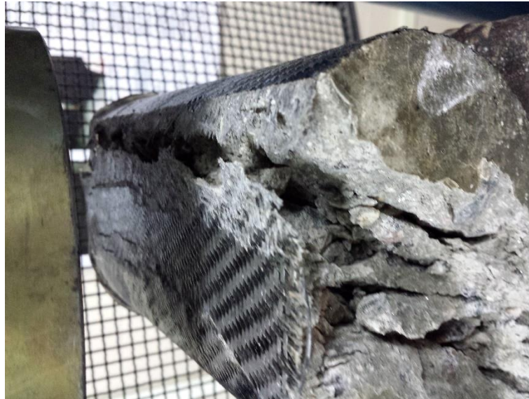
Figura 11 Corpo de prova rompido com reforço na compressão diametral
