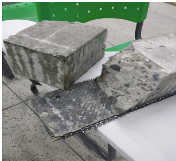
Figura 12 Corpo de Prova prismático após ruptura
