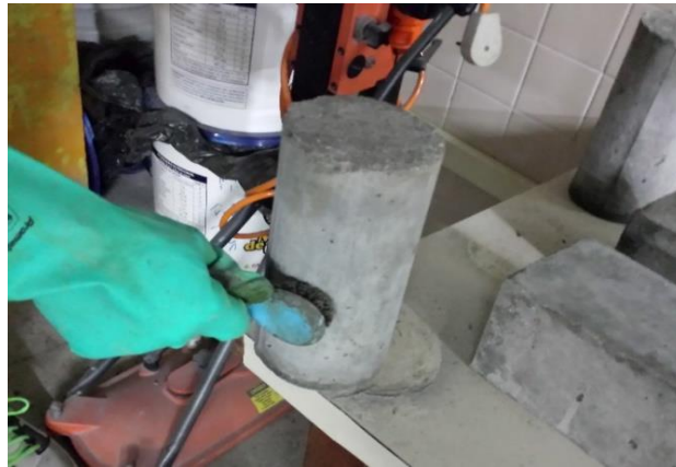
Figura 4 Limpeza Corpos de Prova Cilíndricos
