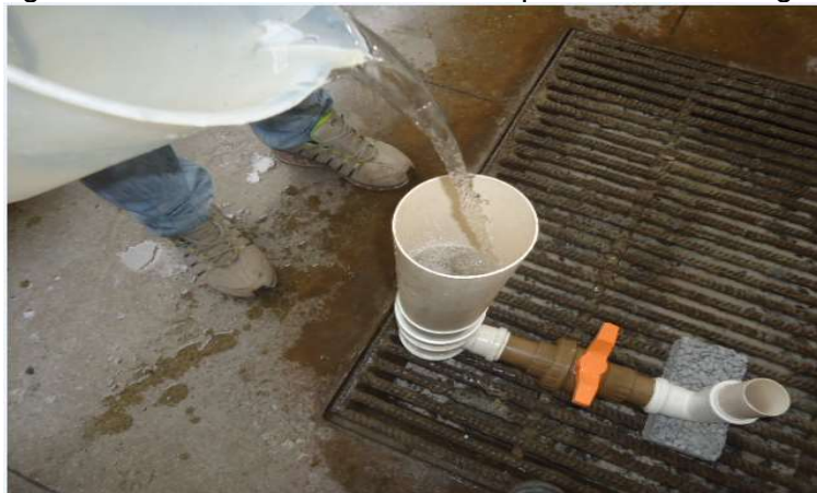
Figura 4 – Tubo acima do CP sendo preenchido com água.
