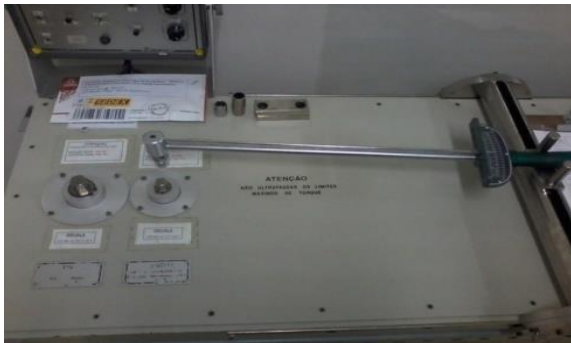
Figura 1: Bancada de torque utilizada nos experimentos. Fonte: O autor (2018).
