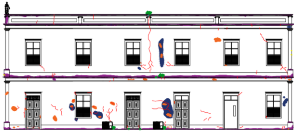
Figura 5 – Mapa de Danos da Fachada Lateral Direita (Fachada Oeste).
