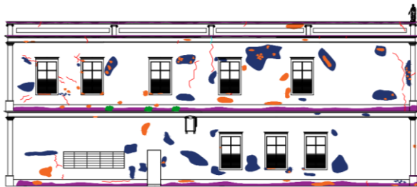
Figura 6 – Mapa de Danos da Fachada Lateral Esquerda (Fachada Leste).
