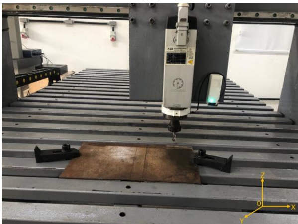
Figura 8 – Fixação da chapa de aço SAE 1045 na Router CNC
