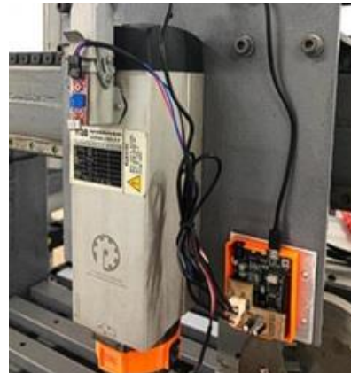
Figura 5 – Primeira versão do sistema de supervisão e monitoramento instalado na Router CNC
