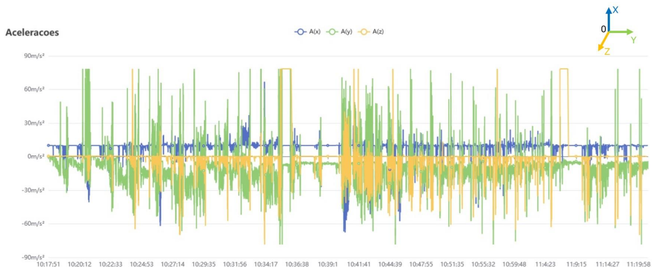
Figura 10 – Print da tela do dashboard dinâmico contendo um gráfico com os sinais de vibração dos eixos X, Y e Z, no domínio da aceleração em função do tempo
