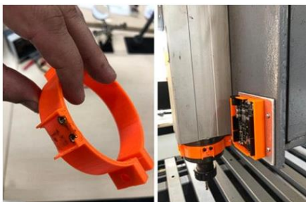
Figura 3 – Dispositivos de fixação produzidos por manufatura aditiva
