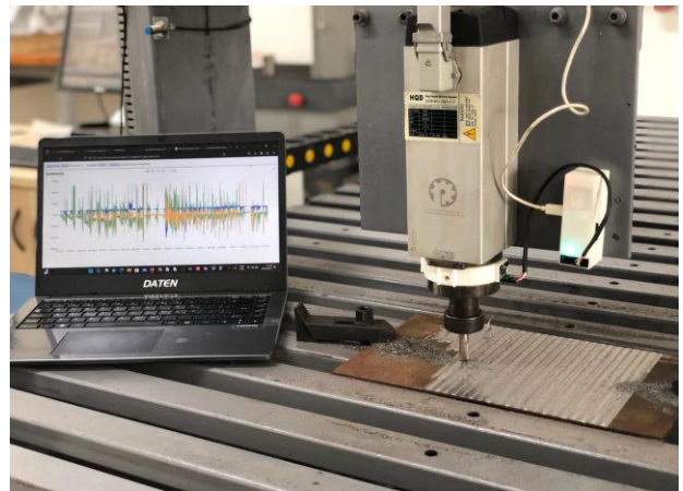
Figura 9 – Fresamento de topo da chapa de aço SAE 1045 com plotagem de gráfico em tempo real através de dashboard dinâmico
