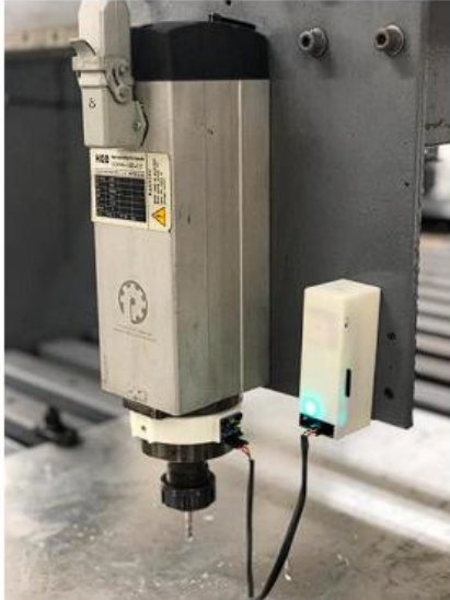
Figura 7 – Versão final do sistema de supervisão e monitoramento instalado na Router CNC
