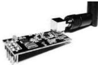
Figura 5: Módulo nRF24L01 transceptor 2,4 GHz.
