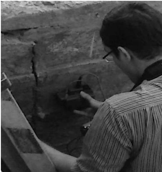
Figura 5: Pacometria para identificar armaduras e cobrimento
