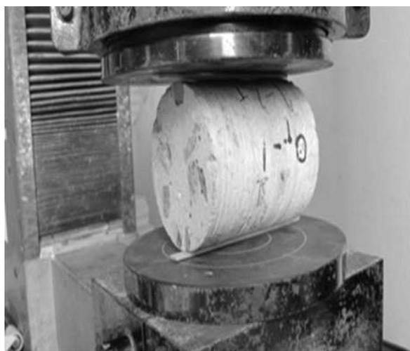
Figura 15: Ensaio de tração diametral [Fonte: Anais do 54º congresso brasileiro do concreto CBC 2012, C. W. de A. P. Sobrinho]
