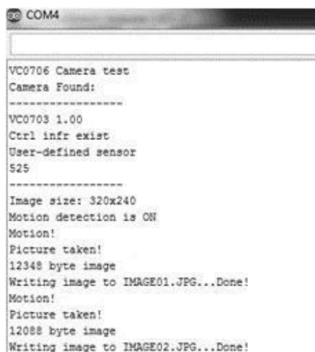
Fig. 8. Informações do teste detecting motion .
