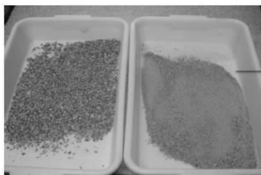
Fig. 3. Separação do material graúdo e miúdo
