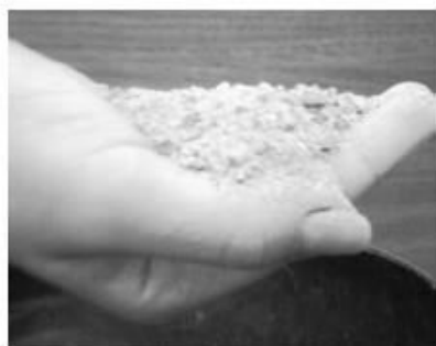
Fig. 1. Resíduo de concreto após o processo de britagem.
