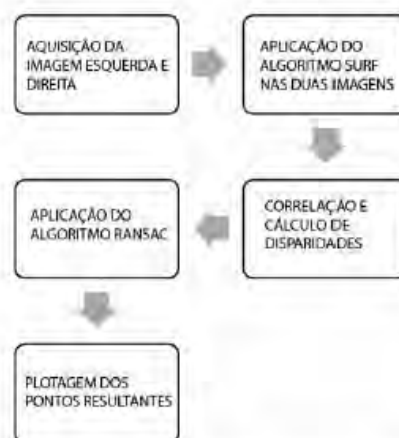
Fig 1. Fluxograma de representação da técnica proposta
