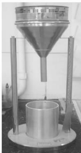
Foto 2 – Aparelho para a determinação de massa unitária
