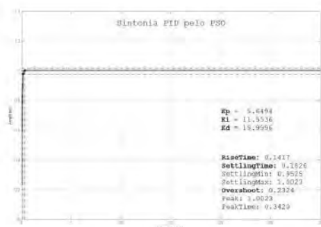
Figura 7: Resposta ao degrau unitário por sintonia PID-PSO.
