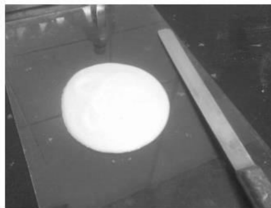
Foto 1 – Pasta de gesso com diâmetro aproximado de 10 cm
