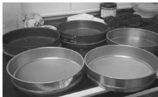
Foto 3 – Peneiras usadas para o ensaio de módulo de finura
