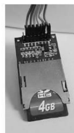
Figura 6 - Módulo SD Shield fabricado pela LC Studio e cartão SD de 4GB
