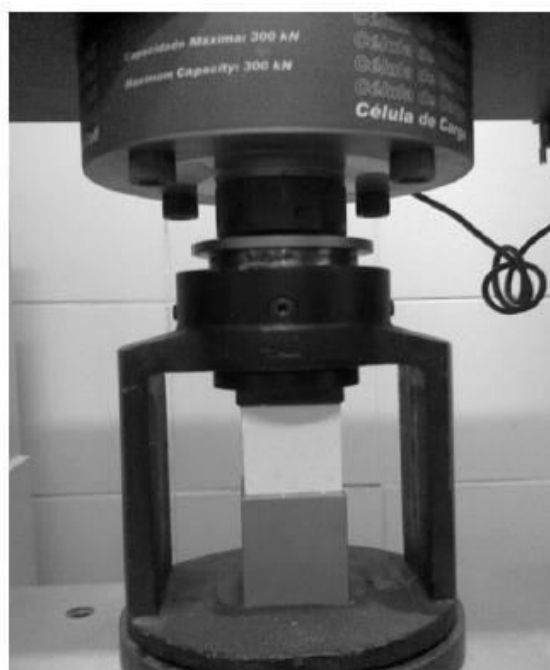
Foto 6 - Ensaio de resistência à compressão
