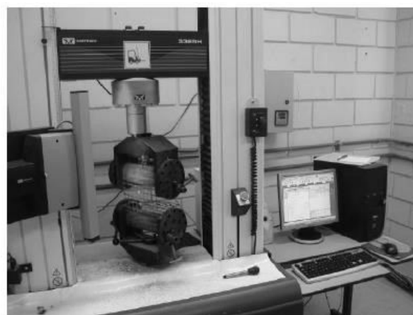
Figura 5. Ensaio de resistência à tração de geogrelha. SANTOS 2011
