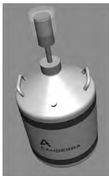
Figura 2: Mecanismo de Resfriamento por N 2 líquido.
