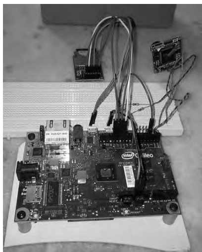
Fig. 10. Montagem da câmera com o galileo.
