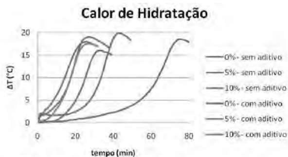
Fig 7. Calor de hidratação de todas as argamassas estudadas
