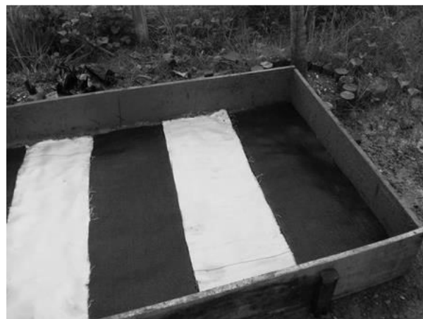
Figura 3. Amostra dispostas alternadamente, em função do tipo de geotêxtil.
