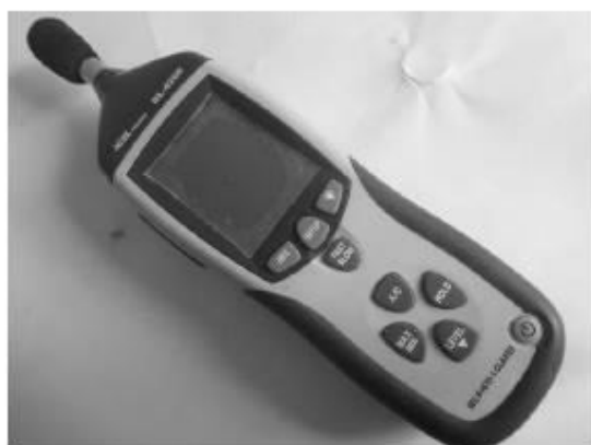
Figura 4 - Decibelímetro DL 4200, fabricado pela Icel
