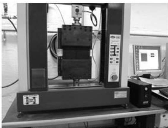
Figura 6. Ensaio de resistência à tração de geotêxteis.
