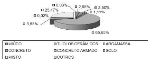
Fig. 3. Composição Gravimétrica do RCD.
