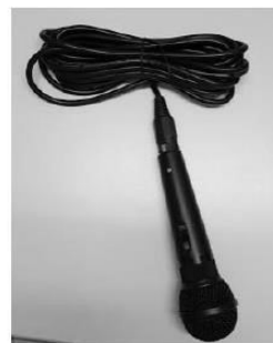
Figura 11 - Microfone GS 36 fabricado pela Alltech. Será utilizado em etapas futuras do projeto.
