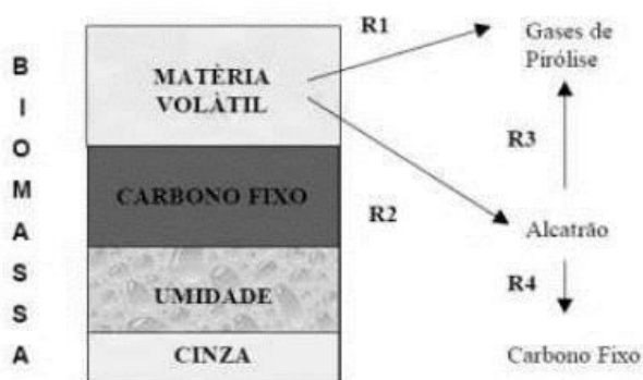
Figura 4. Principais componentes e reação química da biomassa
