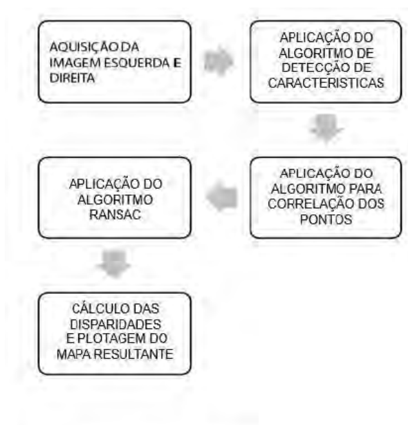
Figura 1: Fluxograma de representação da técnica proposta.
