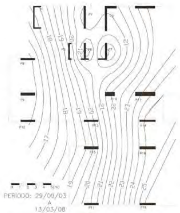
Fig. 13. Curvas de isorecalques da lâmina do prédio na última medição – após o reforço (13/03/2008).
