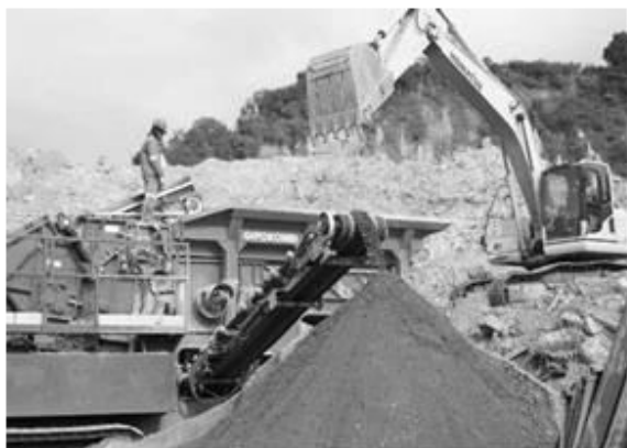
Figura 1. Equipamento empregado na britagem do resíduo. (Blenda soute Maior/DP/DA Press).
