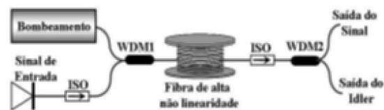
Fig.1: Montagem experimental de um FOPA, WDM1 acoplasi-nal e bombeamento, WDM2 desacopla sinal e idler e remove bombeamento residual, ISO são isoladores ópticos.
