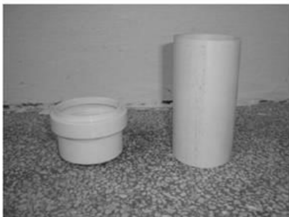
Fig 5. Fôrma de plástico para melhor desmoldagem.
