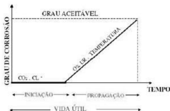
Fig 1. Modelo de Vida Útil proposto por Tuutti
