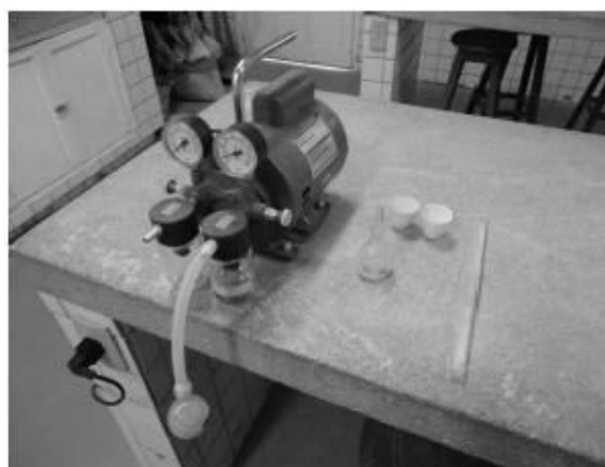
Fig. 6. Bomba de vácuo utilizada no ensaio de massa específica.
