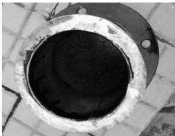
Figura 12. Filtro saturado com alcatrão.
