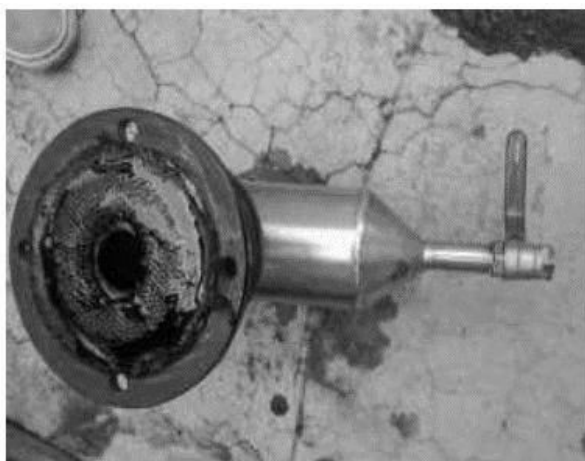
Figura 13. Alcatrão na entrada do filtro trap.
