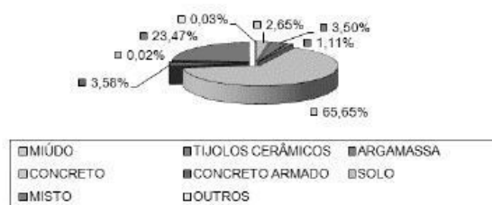
Fig 3. Composição Gravimétrica do RCD.
