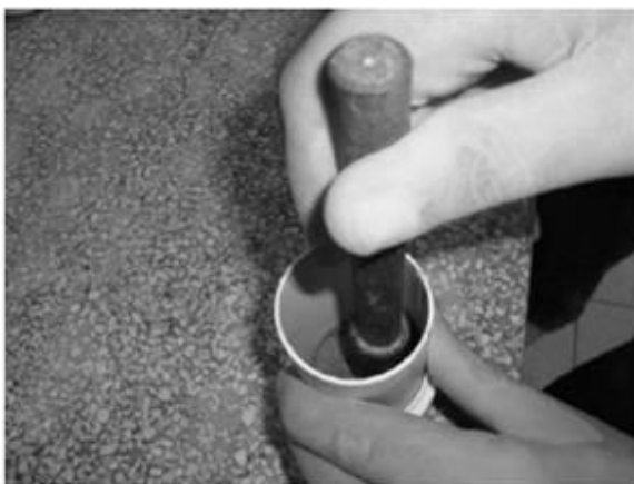
Fig 6. Soquete utilizado para o adensamento das camadas
