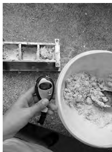
Fig 3. - Tentativa de moldagem de corpos de prova com 100% de resíduo sem aditivo retardador de pega.
