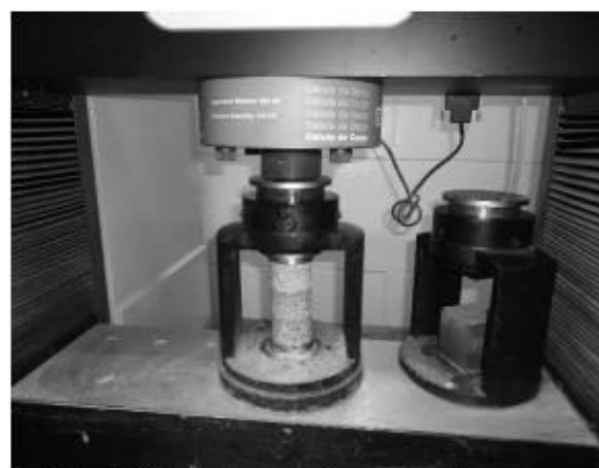
Fig. 9. Rompimento do corpos-de-prova
