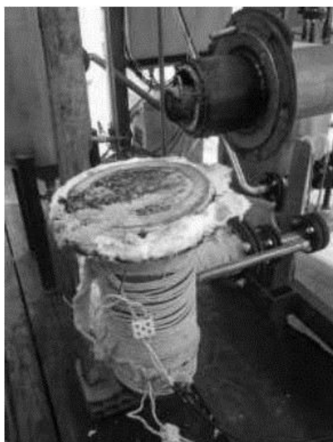
Figura 6. Região do prato de distribuição – zona de pirólise.
