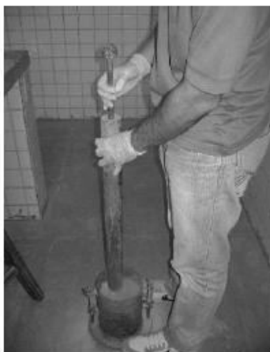
Fig. 7. Compactação do corpo-de-prova.
