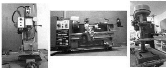
Fig 8. Representação da fresa, torno e furadeira respectivamente.
