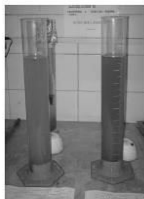
Fig. 5. Material nas provetas para sedimentação.
