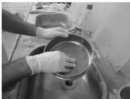
Fig. 4. Lavagem do material miúdo na peneira nº 200.
